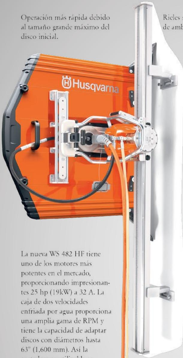
La nueva WS 482 HF tiene uno de los motores más potentes en el mercado, proporcionando impresionantes 25 hp (19kW) a 32 A. La caja de dos velocidades enfriada por agua proporciona una amplia gama de RPM y tiene la capacidad de adaptar discos con diámetros hasta 63" (1,600 mm). Así la cortadora es utilizable en diversas aplicaciones.
